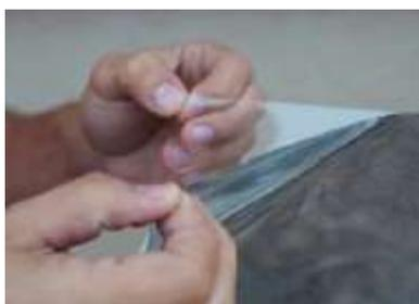
**Paso 4:** Utilice dos trozos de cinta adhesiva, separe el soporte posterior del film.
