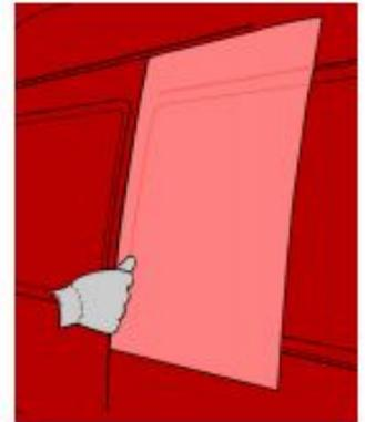
5. Ahora puede comenzar la aplicación del material en la ondulación. Para poder hacerlo sin que queden arrugas ni pliegues, se recomienda humedecer el guante de aplicación de AD con una solución de agua jabonosa.
