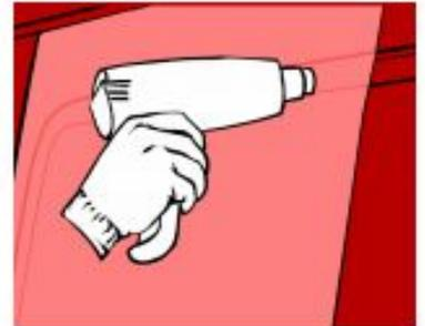
7. Ahora, empiece a estirar el material para adaptarlo a la ondulación, comenzando por la parte más profunda (la parte en la que el material vaya a requerir el mayor estiramiento, como puede ser una esquina). Asegúrese de que el material se caliente para mantenerse a una temperatura de entre 40° y 50°.
