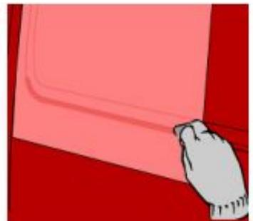
9. Cuando ya se haya terminado la aplicación en las zonas más profundas, se puede continuar con el resto de la ondulación. De nuevo, asegúrese de que el material se caliente a los 40°-50° requeridos y siga por toda la ondulación.
